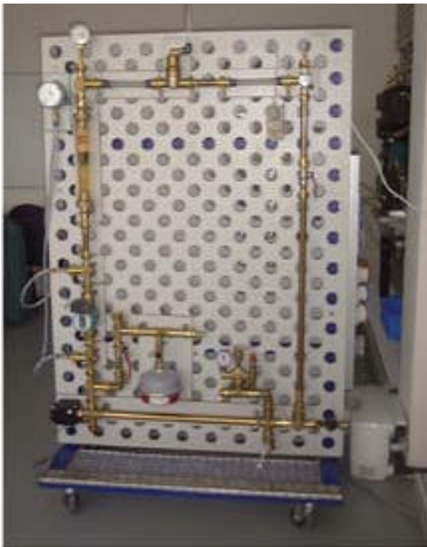
Abb. 3: VAMOS-Versuchsstand für Pumpen
